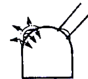
ز - محدود شدن رشد شکستگی ها در اثر فشار شعاعی سیستم نگهداری
